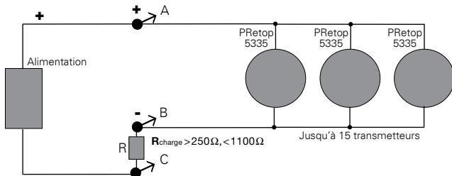
Pour la communication digitale HART® de 2-fils, les sorties de 15 transmetteurs au maximum peuvent être connectés en parallèle.
