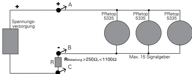
Im Ausgang können bis zu 15 Signalgeber für eine digitale Kommunikation über Zweileiter parallel geschaltet werden.
