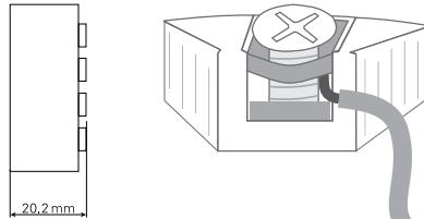
Die Leitungen müssen zwischen den Metallplatten montiert werden.
