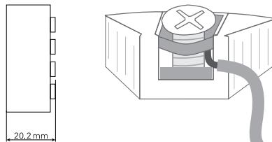
Les fils doivent être montés entre les plaques métalliques.
